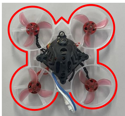
LED チューブをフープ外周全周囲に取り付けている
